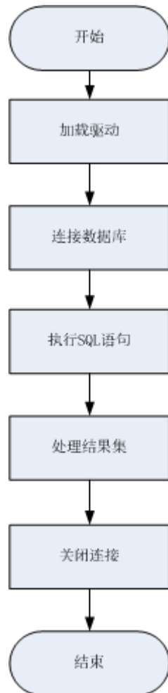
图 5-1 采用 JDBC 开发应用程序的流程
